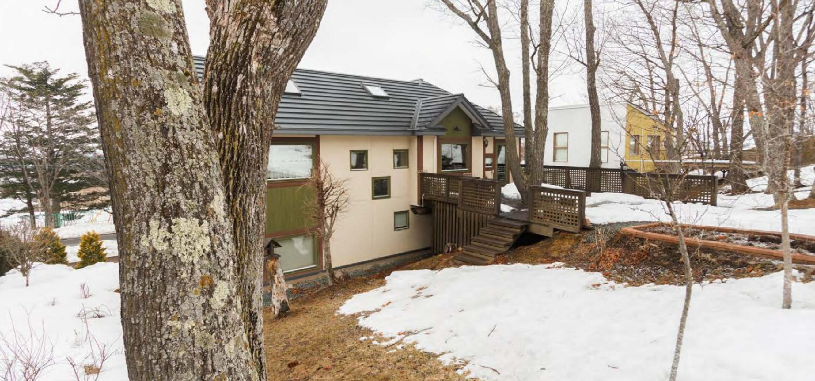
傾斜地を利用して、2階から裏庭の木製デッキに出られるようになっています。屋根は「スノーストッパーーフ」(雪止めリブの入った屋根材)によって落雪を防ぐ仕様です。
